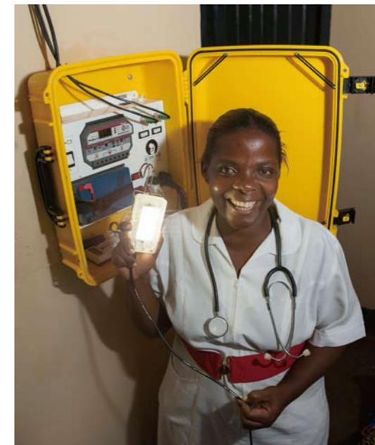
可装在行李箱的太阳能发电系统，整合有太阳能发电板、充电池、充电控制器、LED灯，可以直流电迅速支援产前心脏监测器等医疗器材使用，意在提供简易而易于取得的电力，并于夜间提高妇女生产的安全性。
