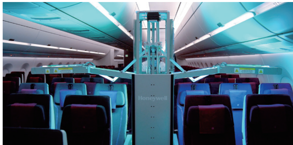
卡达航空与Honeywell公司的航太部门合作，设计的专用紫外线杀菌机器人，在机舱执行消毒勤务
