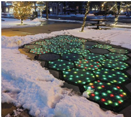
铺设在路面的太阳能板可通过发热机制，为严寒气候地区省去铲雪、除冰的困扰。
