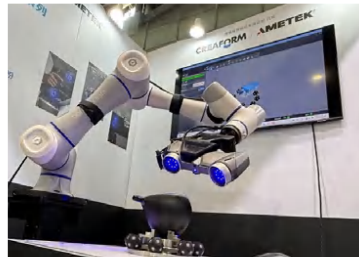
左：Stratasys F3300机型以高精度、速度与稳定性领先，支援多种工程材料，满足电子业需求。右：通业技研将Creaform手持激光3D扫描结合协作型机械手臂打造全自动快速检测。
